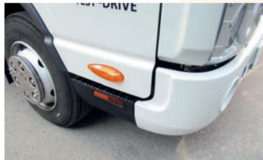
Верхние ступеньки кабины JAC N120 прикрыты нижней частью дверей, а потому всегда остаются чистыми
