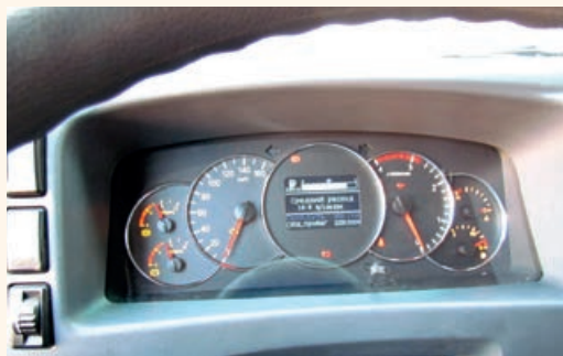
В центральной части приборного щитка – небольшой дисплей, на который выводится вся наиболее актуальная информация, включая данные по потреблению топлива
