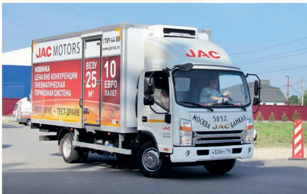
Полная масса JAC N75 составляет 7,5 т, грузоподъемность шасси – 4,5 т
