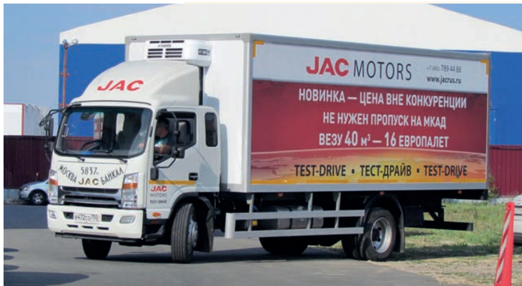
Полная масса JAC N120 составляет 12 т, грузоподъемность шасси – 7,7 т
