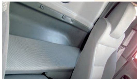
В задней части кабины JAC N120 организовано спальное место. Чтобы водителю на нем расположиться, нужно откинуть спинки двухместного пассажирского сиденья
