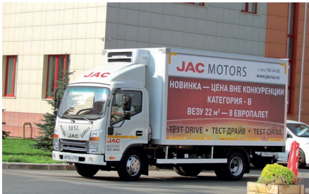
В России JAC N56 позиционируется как 3,5-тонное шасси, хотя реально его допустимая конструкцией полная масса 5,6 т
