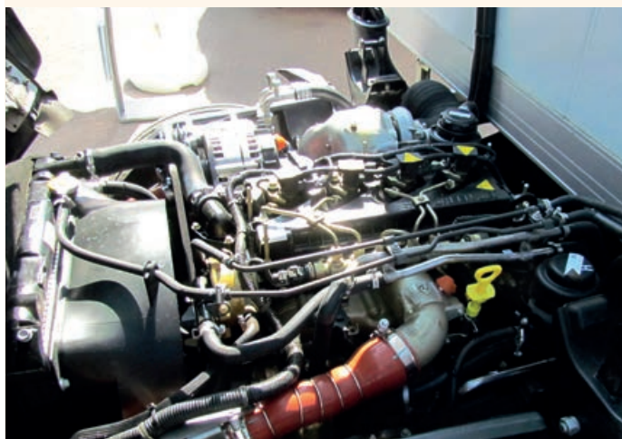
Под кабиной JAC N56 скрывается 2,8-литровый дизель Green Jet мощностью 150 л.с. По сути – аналог Cummins
