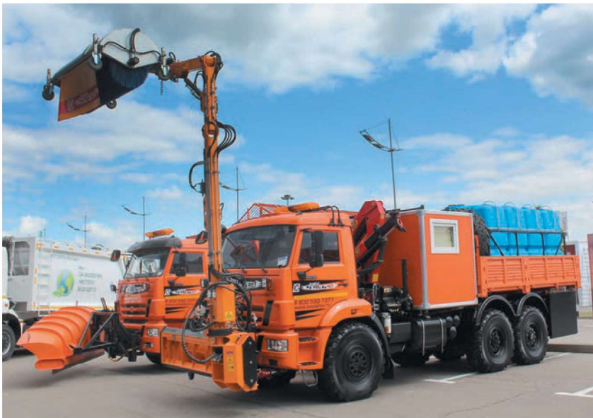
Тоннелемочная машина ВМКД-2015, рядом коммунальная самоходная машина «Тройка-2012»
