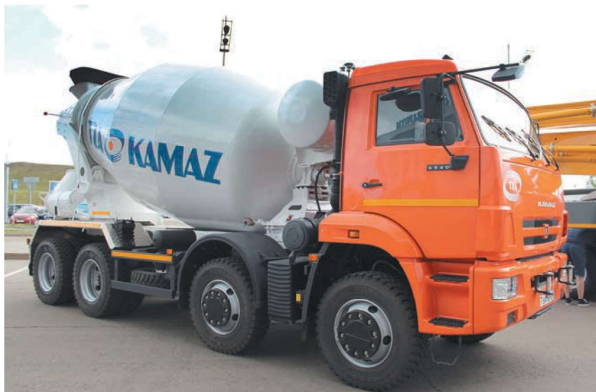
Девятикубовый автобетоносмеситель АБС 5814У9-01 Туймазинского завода автобетоносмесителей на шасси КамАЗ-6540
