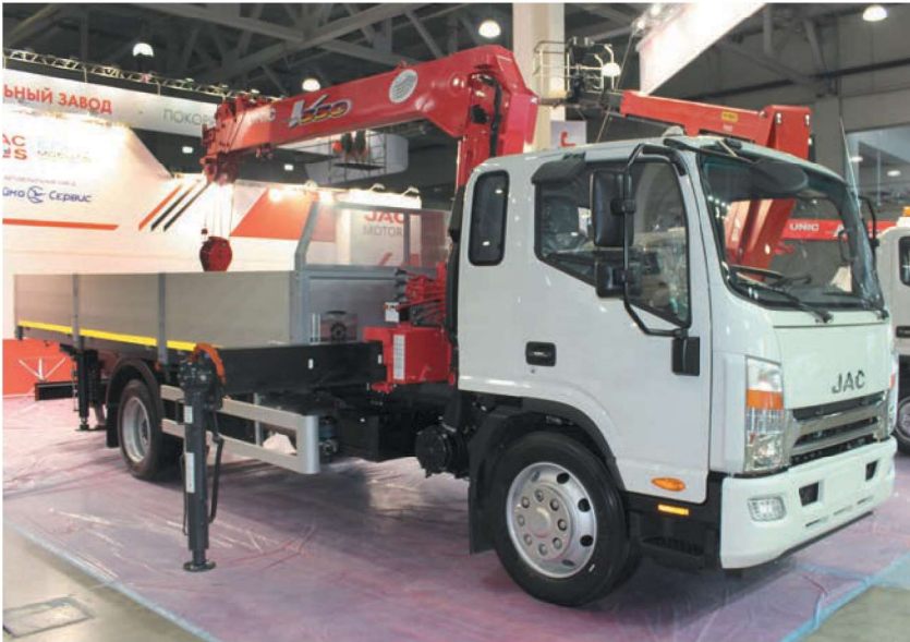
Бортовой автомобиль JAC N120 с крано-манипулятором установкой Unic 554
