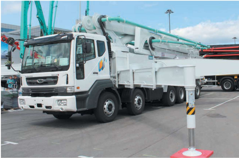
Автобетононасос КСР63ZX на шасси Daewoo Novus
