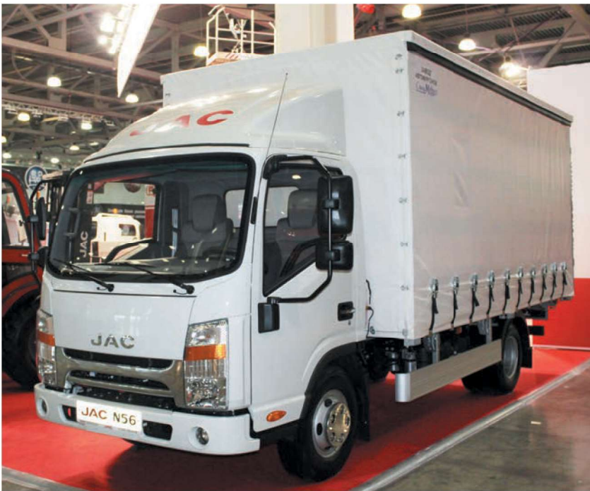
Шасси JAC N56 в комплектации со шторной бортовой алюминиевой платформой
