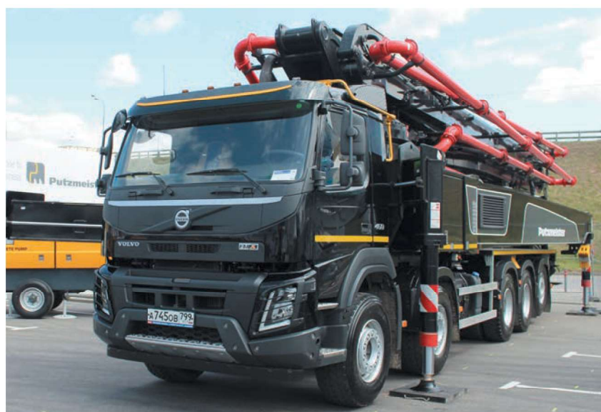
Бетононасос М56-5 компании Putzmeister на шасси Volvo FMX
