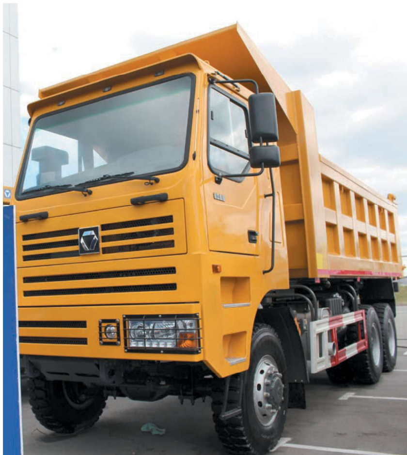
Полноприводный 31-тонный карьерный самосвал XCMG XGA5470D3TQ
