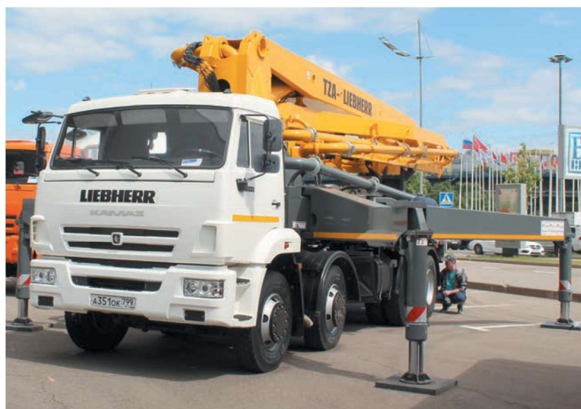
Автобетононасос TZA-Liebherr на шасси КамАЗ-6540-1910
